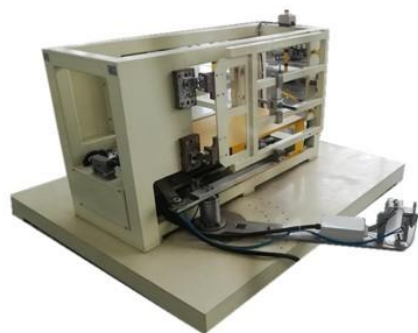
汽车侧门铰链耐久性寿命试验机
