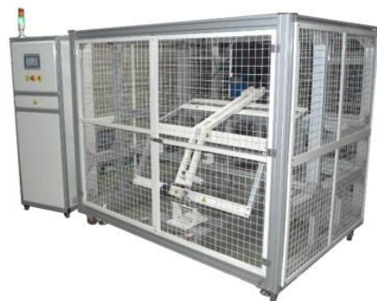
汽车尾门铰链耐久性寿命试验机
