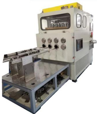
汽车换挡器 耐久性寿命试验机
