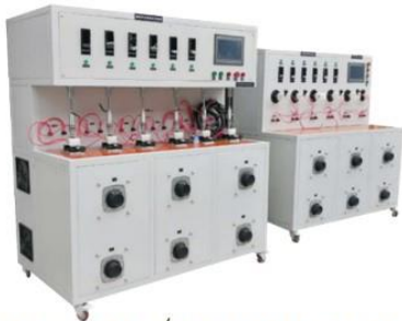
旋扭开关/倾倒式开关寿命试验机
