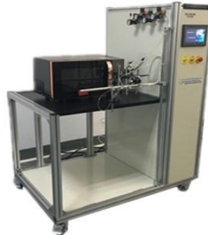
整机按键开关寿命试验机
